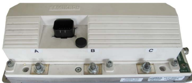
Rys 6. Przemiennik częstotliwości zasilający silnik tarczowy oraz silnik cylindryczny z magnesami trwałymi.
