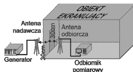
Rys.2. Przykładowy układ pomiarowy do określenia poziomu pola tłumionego
