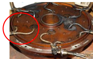
Zdj. 2. Oporniki stopniowe z widocznymi śladami przegrzania
