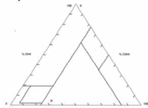
Rys. 10. Trójkąt Duvala typ 2 z naniesionym punktem w strefie X3 na elementach izolacyjnych
