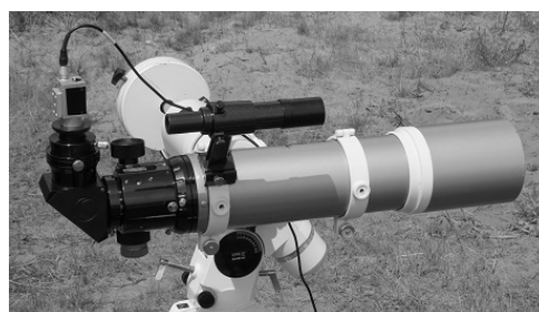
Rys. 11. Tor optyczny stanowiska do pomiaru opóźnień video
