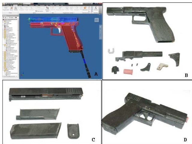
Rys.2. Etapy metody druku 3D: A-model bryłowy pistoletu, B-szkielet pistoletu, elementy składowe pistoletu, C- zamek pistoletu, elementy magazynka pistoletu, D-model pistoletu wytworzonego metodą 3D, po złożeniu [20]
