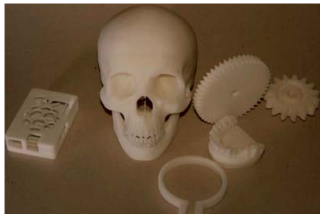
Rys.3. Proste modele 3D wydrukowane techniką FDM [21]
