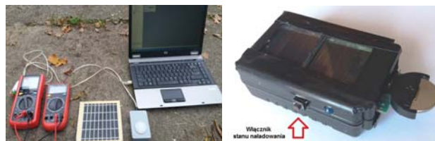
Rys. 3. Przykładowe zdjęcia ładowarek słonecznych skonstruowanych w WITI na bazie baterii litowo-jonowych [5].
