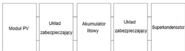
Rys. 5. Schemat blokowy skonstruowanej ładowarki słonecznej w WITI na bazie hybrydowych magazynów energii.
