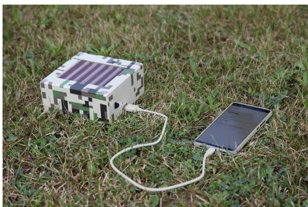
Rys. 8. Układ zasilający z ogniwem barwnikowym i superkondensatorami w kamuflażu pustynnym
