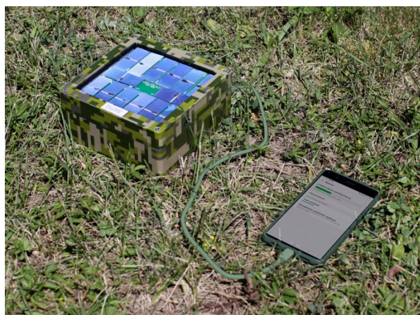
Rys. 9. Układ zasilający z ogniwem krzemowymi i superkondensatorami w kamuflażu leśnym
