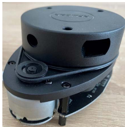
Rys. 3 Moduł skanera laserowego SLAMTEC RPLIDAR A1M8
