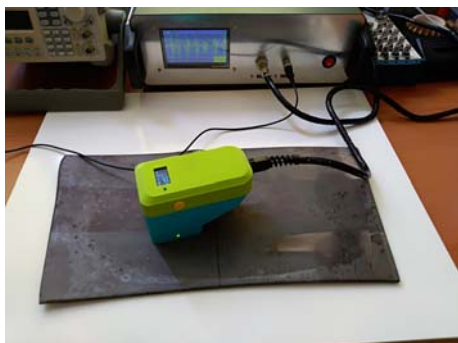
Rys.1. Ogólny widok opracowanej głowicy pomiarowej podłączonej do jednostki głównej aparatury pomiarowej
