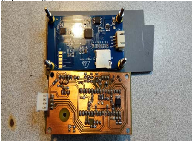
Rys. 2. Prototyp układu podczas montażu podzespołów elektronicznych
