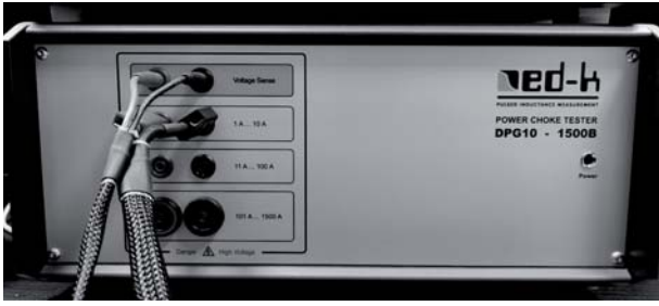
Rys. 6. System pomiarowy EDK DPG-10
