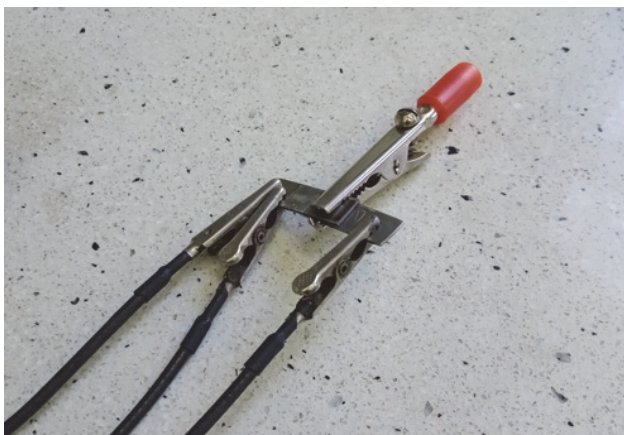
Rys.2. Badany superkondensator zawierający elektrolit z solą \text{LiClO}_4
