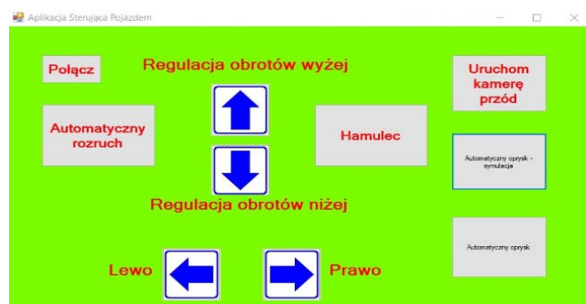
Rys. 4. Aplikacja sterująca zdalnie ciągnikiem sadowniczym wraz z automatycznym opryskiwaczem
