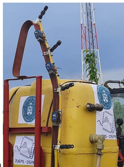
Rys. 1. Automatyczny opryskiwacz sadowniczy: (a) widoczna kamera czołowa przymocowana do maski ciągnika rolniczego, (b) widoczna kamera boczna przymocowana do kabiny ciągnika rolniczego, (c) zmodernizowany opryskiwacz wyposażony w zespoły sterowanych dysz
