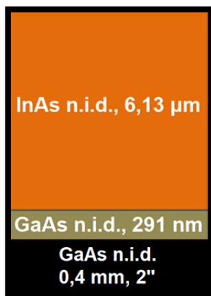
Rys. 1. Schemat architektury badanej warstwy, struktury epitaksjalnej InAs osadzonej za pomocą metody MBE na podłożu GaAs.
