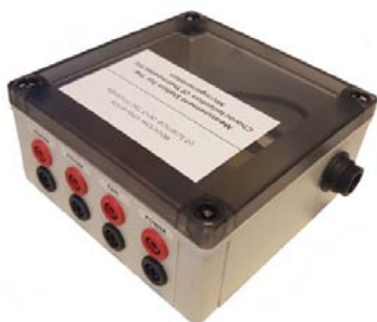
Rys. 5. Tył sterownika z wejściami na złącza bananowe i przewód mini USB.
