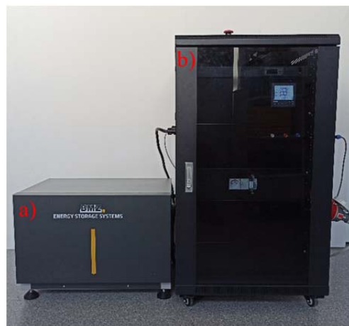
Rys. 7. Stanowisko użyte do badań a) magazyn energii firmy BMZ Poland 10 kWh, b) przekształtnik czteroprzewodowy
