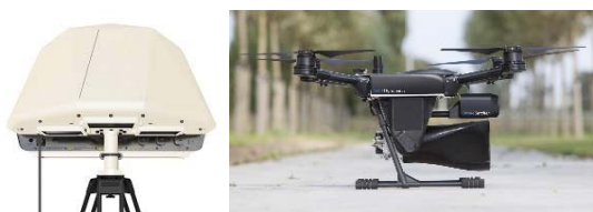
Rys. 3 QinetiQ(OBSIDIAN) wraz z dronem „chwytaczem” wyposażonym w sieć do łapania BSP [7]
