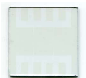
Rys. 5. Próbkę z naniesioną i wytrawioną lokalnie warstwą ITO oraz PEDOT: PSS
