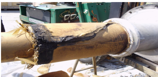
Rys. 8. Kanał przepływu prądu przez rdzeń izolacyjny
