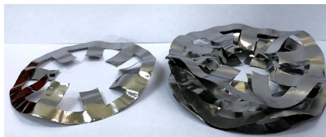
Rys.1. Pierścienie wycięte z taśmy amorficznej
