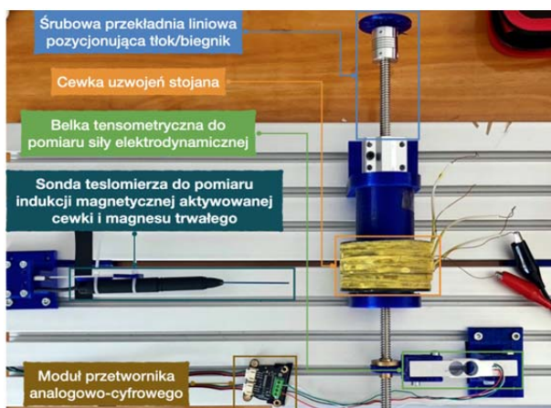
Rys.3. Układ: cewka — magnes trwały na stanowisku badawczym — widok z góry (pomiar siły realizowany za pomocą belki tensometrycznej i przekładni śrubowej).
