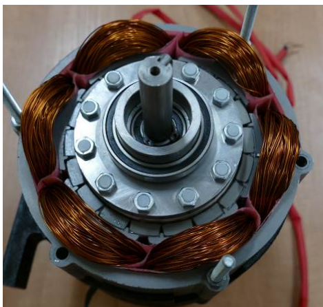
Rys. 11. Prototyp maszyny elektrycznej z zintegrowaną przekładnią magnetyczną o strukturze MGPM
