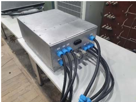
Rys. 24. Widok prototypu falownika 6 fazowego do napędów autobusowych, samochodów osobowych i ciężarowych oraz innych pojazdów użytkowych oraz przemysłowych
