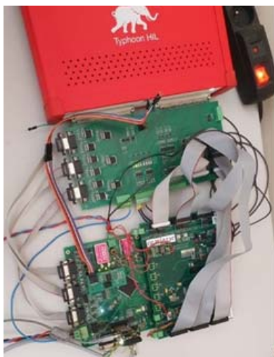
Rys. 7. Stanowisko badawcze HIL sterowania wektorowego FOC napędu 6-fazowego PMSM
