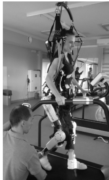
Rys.2. System HAL w trakcie rehabilitacji [2]
