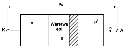
Rys.1. Przekrój struktury diody PiN
