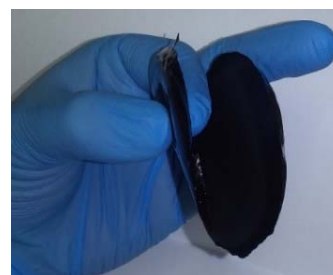
Rys. 7. Zdjęcie warstwy kompozytu L,D-PLA:5CB:SWCN (10:1:0,5)
