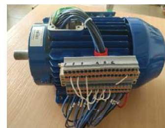
Rys.1. Geometria (a) i prototypowa maszyna indukcyjna przystosowana do zasilania dwukanałowego (b)
