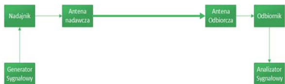
Rys. 7 Schemat przedstawiający pomiar wartości sygnału w miejscu odbioru w wolnej przestrzeni
