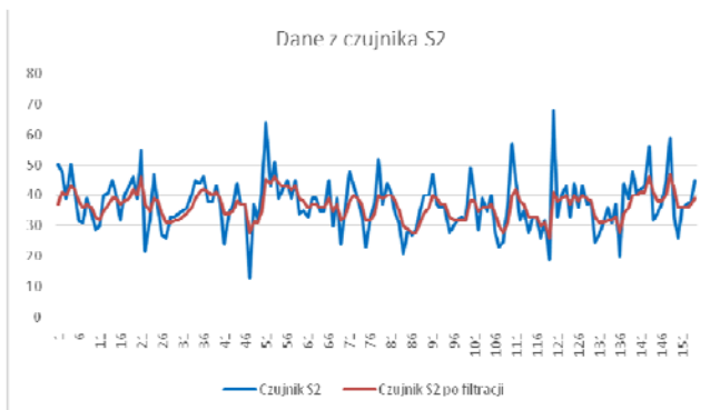
Rys. 12. Przykładowe przebiegi drgań z czujnika S2 przed i po filtracji Kalmana
