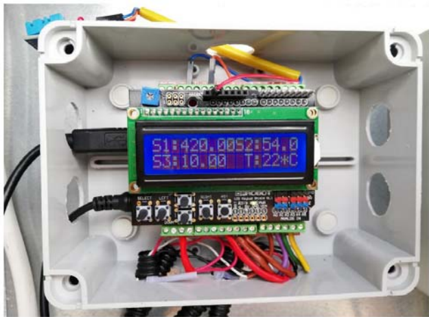
Rys. 6. Widok jednostki centralnej z mikrokontrolerem Arduino Uno R3 wraz wyświetlaczem w hermetycznej obudowie
