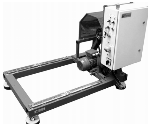
Rys.2. Hamownia silnikowa inercyjna HST-12i Świątek
