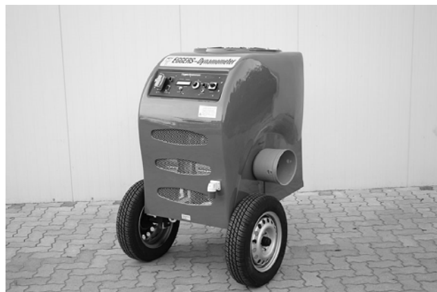
Rys.3. Mobilna hamownia WOM Egger PT170 z hamulcem elektrowirowym (retarder) chłodzonym powietrzem do testowania ciągnikowych silników spalinowych do 300kW
