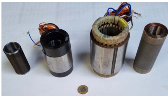
Rys. 1. Stożan i wirnik silnika indukcyjnego o mocy 6,3kW, prędkości obrotowej n_N=79800\text{obr/min} i znamionowej częstotliwości stojana f_s=2667\text{Hz} . (po prawej) oraz, dla porównania, silnika z magnesami trwałymi o mocy 6kW (po lewej)
