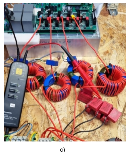
Rys. 2. Opracowany falownik SiC o mocy 12kVA i częstotliwości przełączania tranzystorów 100kHz (tu w konfiguracji 4-gałęziowej): wizualizacja CAD (a); widok płyty sterowników bramkowych (b); stanowisko z 4-gałęziowym filtrem sinusoidalnym (c)
