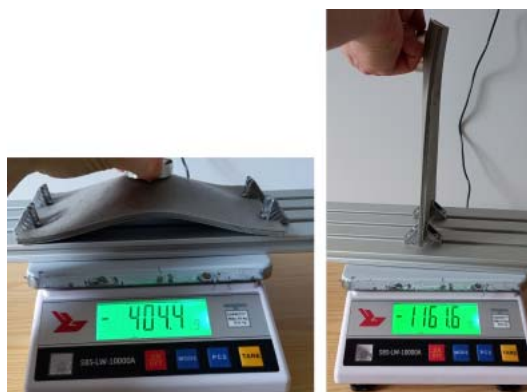
Rys.9. Pomiar siły działającej w kierunku normalnym lub stycznym do powierzchni próbki prostokątnej za pomocą wagi laboratoryjnej
