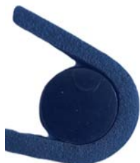
Rys.5. Próbka paskowa zwinęta za pomocą magnesu 1
