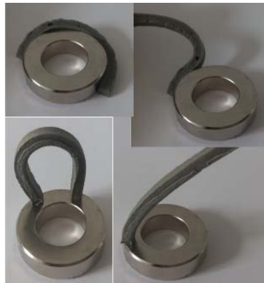
Rys.8. Próbka paskowa kształtowana na różne sposoby za pomocą magnesu 2
