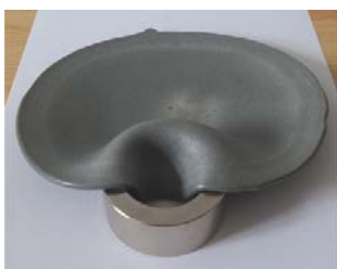
Rys.6. Próbka kołowa zdeformowana za pomocą magnesu 3
