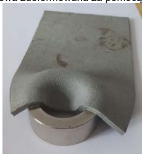
Rys.7. Próbka prostokątna zdeformowana za pomocą magnesu 3
