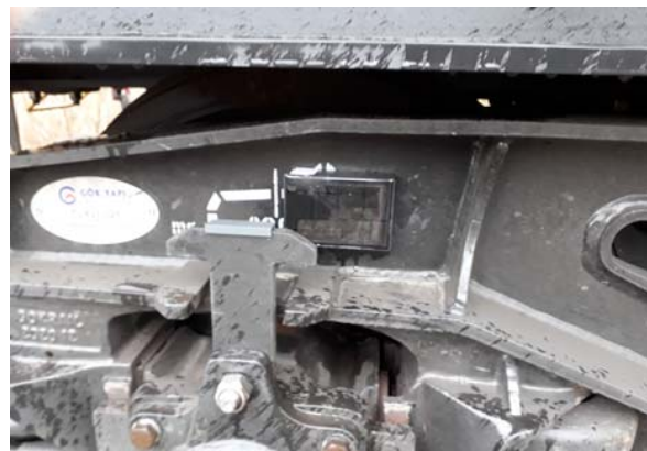
Rys.7. Umiejscowienie sensora załadunku wagonu na wózku kolejowym
