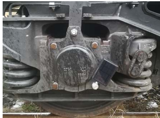
Rys.3. Umiejscowienie sensora wibracji oraz sensora temperatury łożyska osiowego
