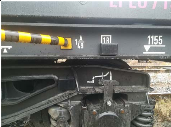
s.8. Jednostka centralna zamontowana na wagonie kolejowym wraz z sensorem temperatury koła pojazdu kołowego
