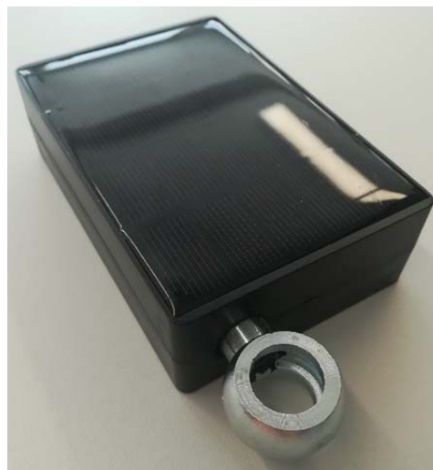
Rys.4. Sensor wibracji oraz sensora temperatury łożyska osiowego
