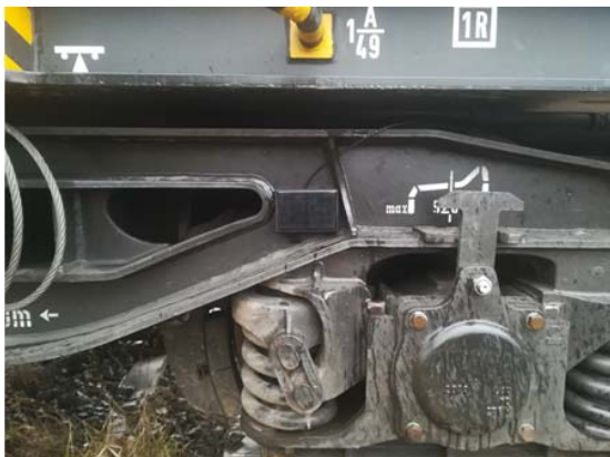
Rys.5. Umiejscowienie sensora temperatury koła na wózku kolejowym (część zasilająca)
