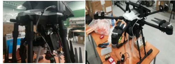
Rys. 9. Urządzenia zamontowane na pokładzie BSP
