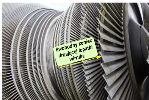
Rys.1. Widok wirnika maszyny wirnikowej turbiny parowej
