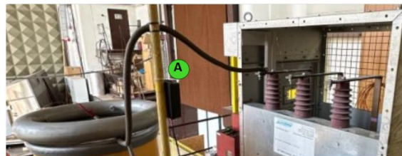
Rys. 7. Widok anteny UHF zamontowanej w pobliżu źródła WNZ
