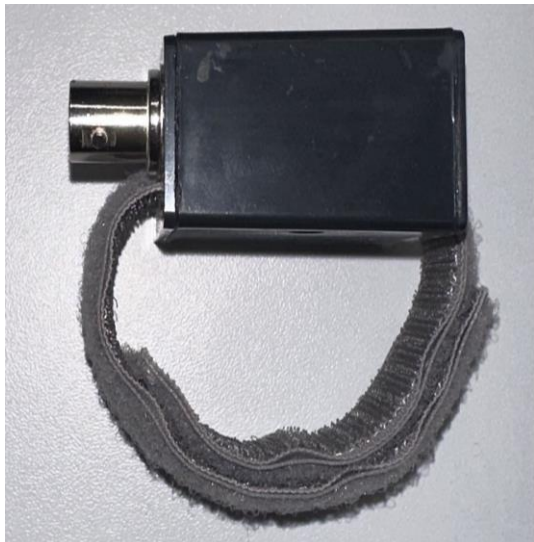
Rys. 4. Przykład sensora HFCT wykonanego w oparciu o elastyczny rdzeń z materiału nanokrystalicznego
